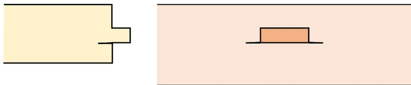
Der Zapfen ist immer noch eine ideale Steckverbindung, um den Zusammenbau und/oder das Aufrichten zu erleichtern. Er sollte nicht mehr als reine Querkraftverbindung verwendet werden. Ist er gesteckt, kann der Anschluss mit Vollgewindeschrauben vollkommen gemacht werden.
